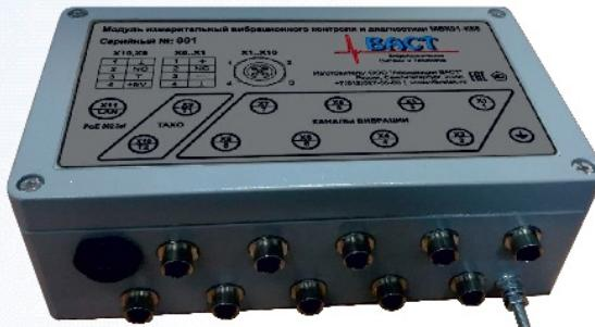
Модуль MBK01 предназначен для измерения и передачи во внешние системы параметров вибрации и частоты вращения.
